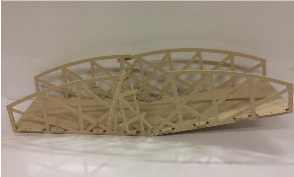
Slika 21: Zlomljen okvirni most z navpičnimi stebri.
