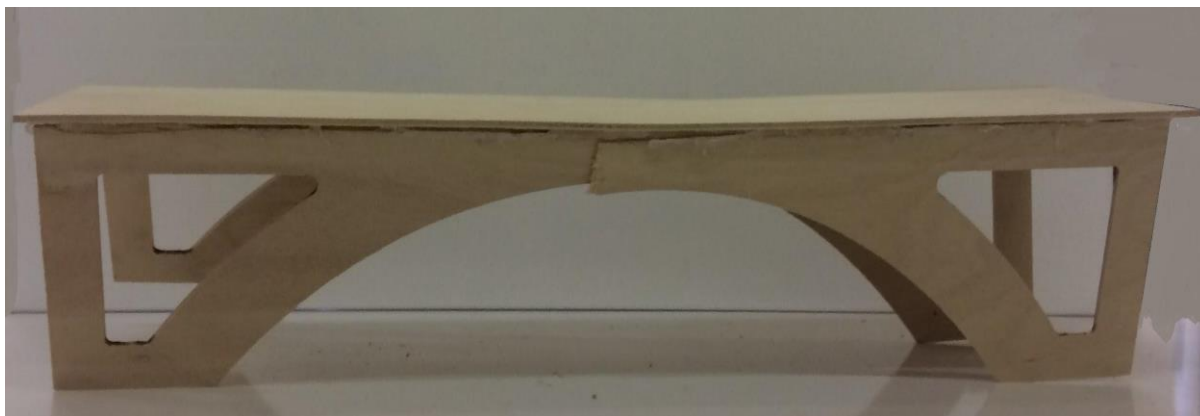
Slika 18: Zlomljen ločni most.
