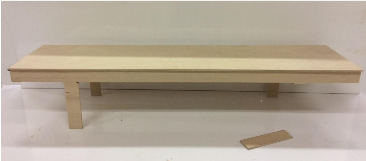
Slika 19: Zlomljen gredni most.
