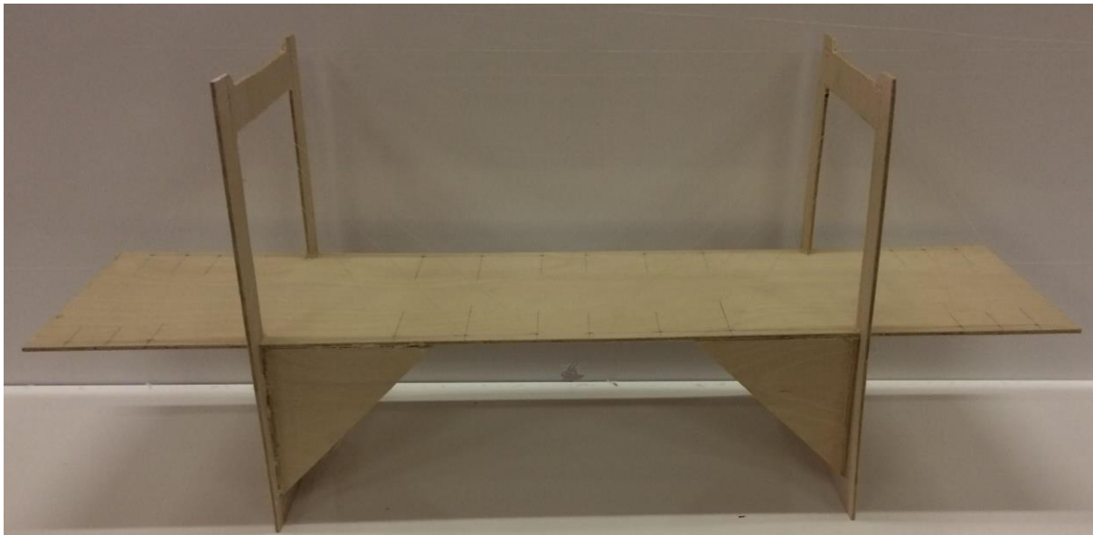
Slika 11: Maketa mosta s poševnimi zategami.
