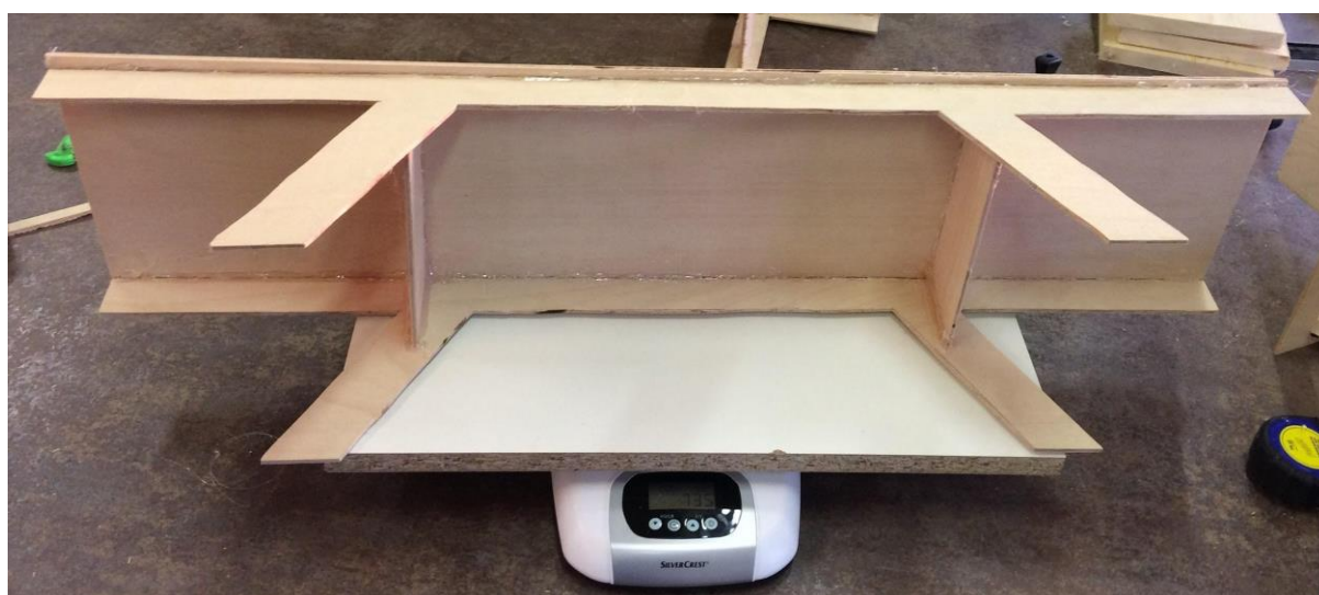
Slika 15: Tehtanje okvirnega mostu s poševnimi stebri.
