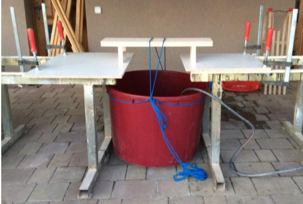
Slika 16: Preverjanje nosilnosti grednega mosta.
