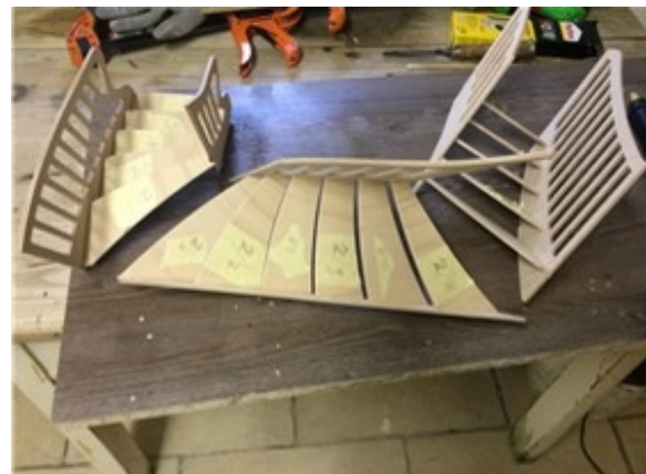
Slika 34: Lepljenje in sestavljanje delov. (Avtorica: Karla Rap, Laporje, 14. 1. 2020)
