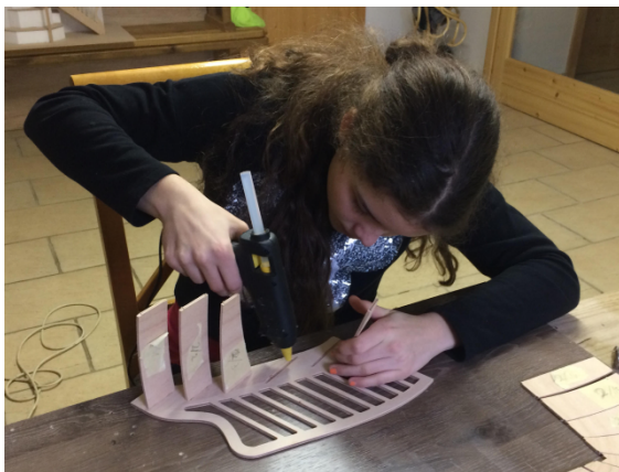
Slika 33: Lepljenje s talilnim lepilom. (Avtorica: Karla Rap, Laporje, 14. 1. 2020)
